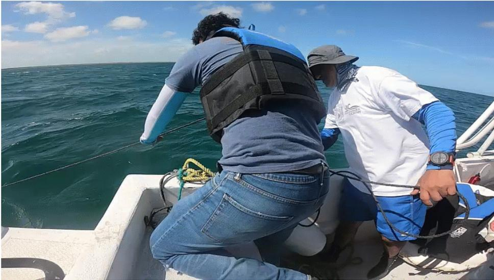
Pasado el tiempo del arrastre se subirá comenzando por la boca de la red. El cronómetro se detendrá cuando el flujómetro salga del agua.
