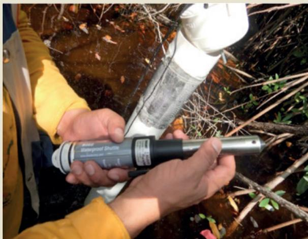
Sensor automático de presión marca HOBOTM
